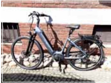
Ein Pedelec mit integriertem Akku.
